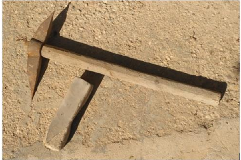
Ilustración 2. Pico de cantero muy usado y bien afilado junto a un asperón con su forma original y huellas de uso (pico y asperón de Felisa Velasco Cervantes. Fotografía propia).
